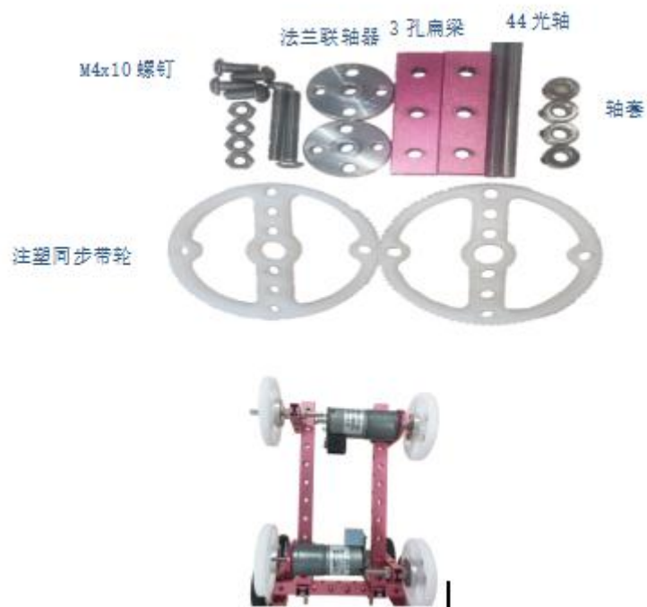
图 8 安装注塑带轮
