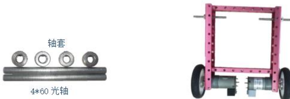
图 3 安装后轮支架
