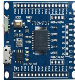
图 5 51 单片机最小系统板
