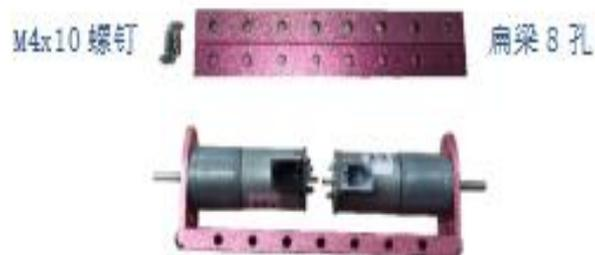
图 5 组装后轮电机
