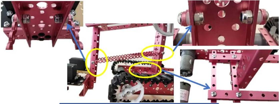
图 10 固定机械爪和掌控板底座
